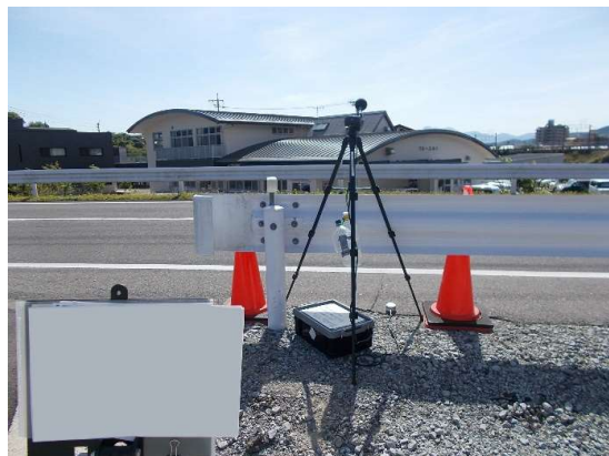
騒音振動調査状況
