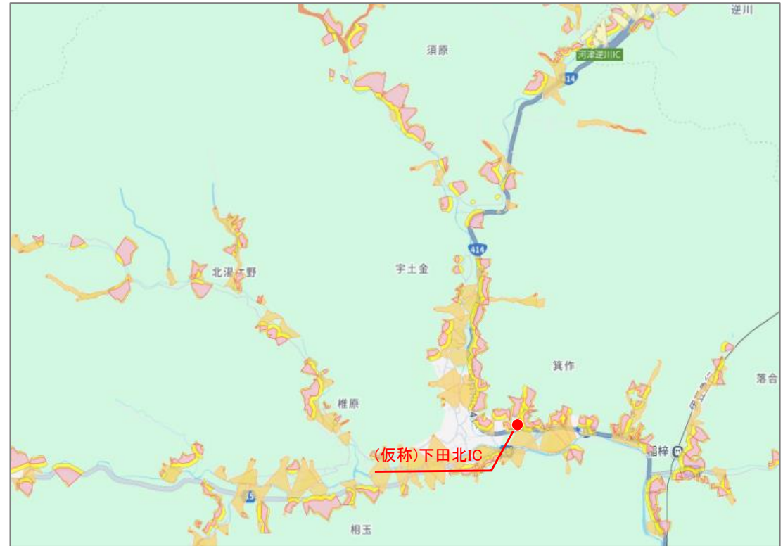
(仮称)下田北IC周辺の土砂災害特別警戒区域
